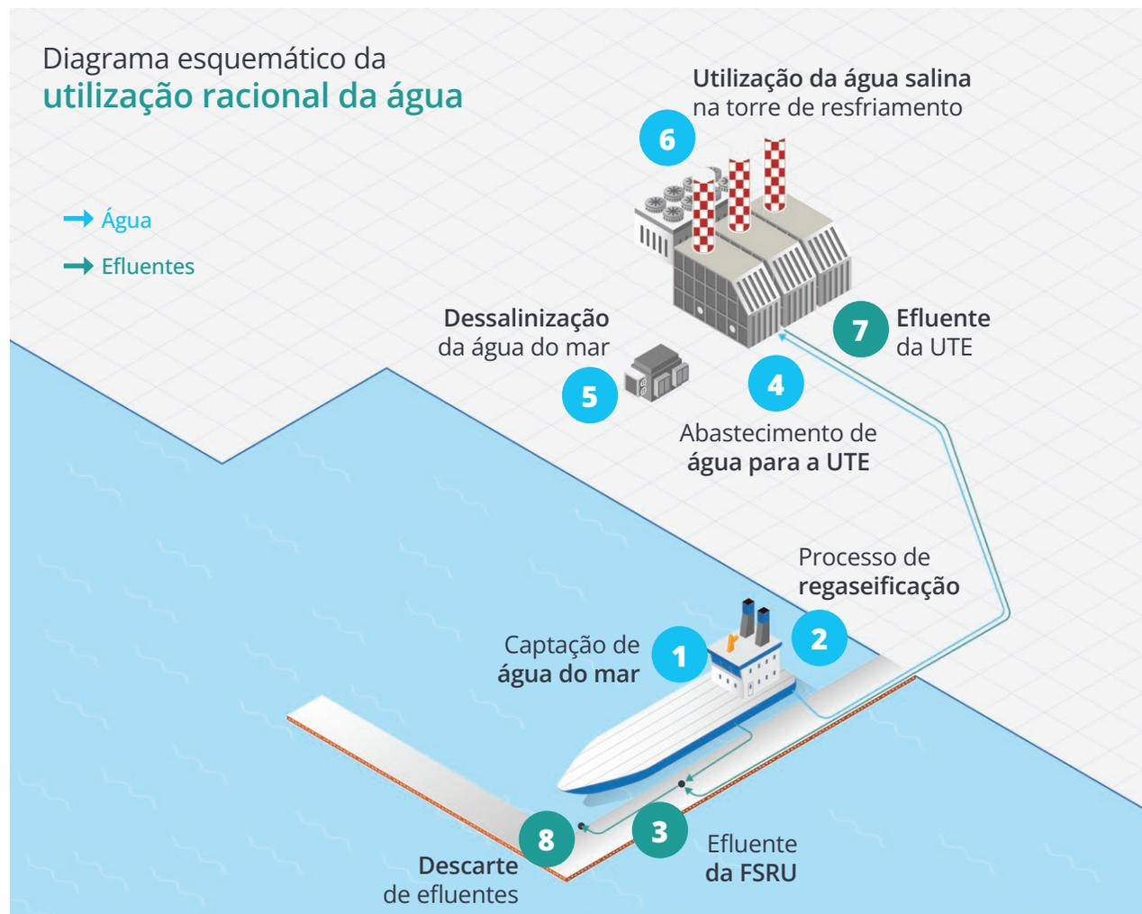
O reúso do efluente de processo da FSRU traz ganhos de eficiência na geração de energia pela UTE GNA I. Durante o processo de regaseificação, a temperatura da água do mar é reduzida em cerca de 5 °C. Assim, sua utilização na torre de resfriamento resulta no aumento da eficiência do ciclo térmico da planta.
