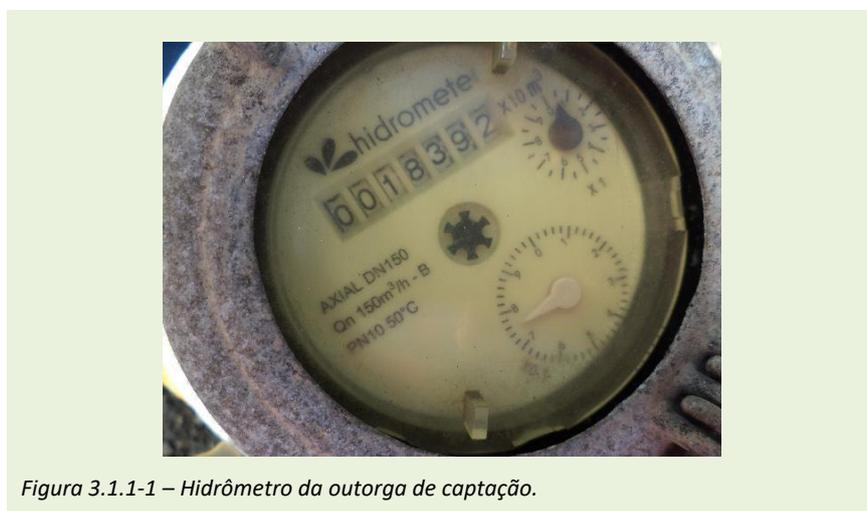
Figura 3.1.1-1 – Hidrômetro da outorga de captação.
