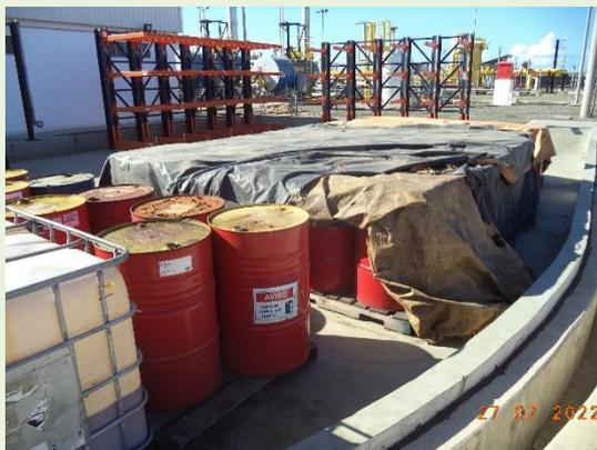
Foto 8: Embora o local possua contenção, a mesma não está ligada ao sistema de drenagem oleosa, o que faz com que, em caso de vazamentos, o líquido necessite ser escoado adequadamente.
