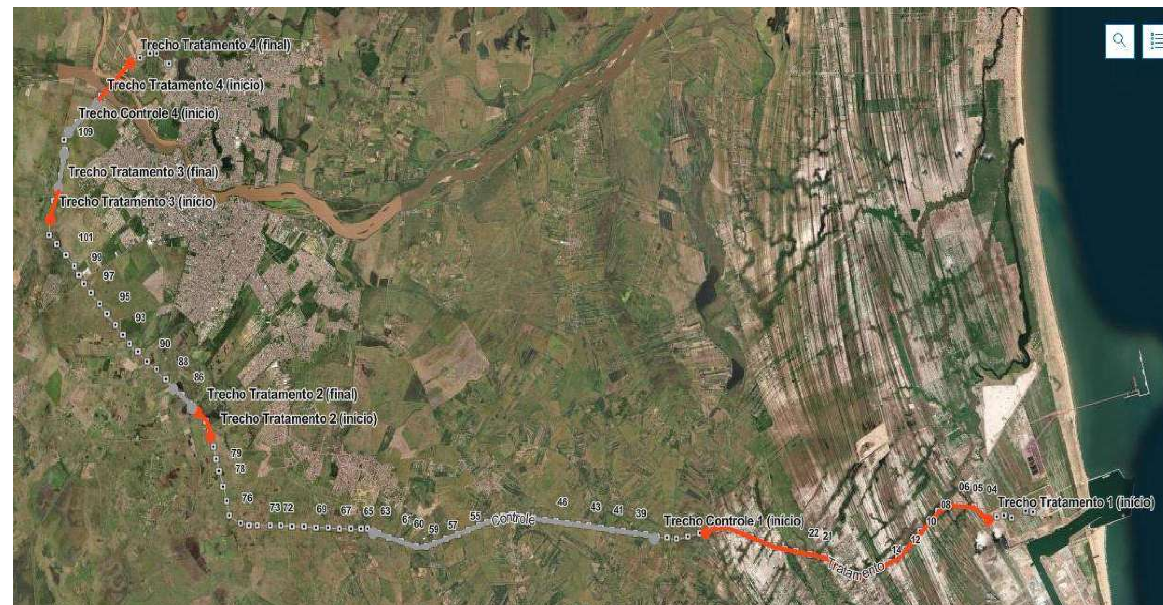
Áreas onde foram instalados os dispositivos anticollisão e anti-eletrocussão na LT 345 kV. FONTE: 1º RELATÓRIO ANUAL DO BAP, JGP 2020.
