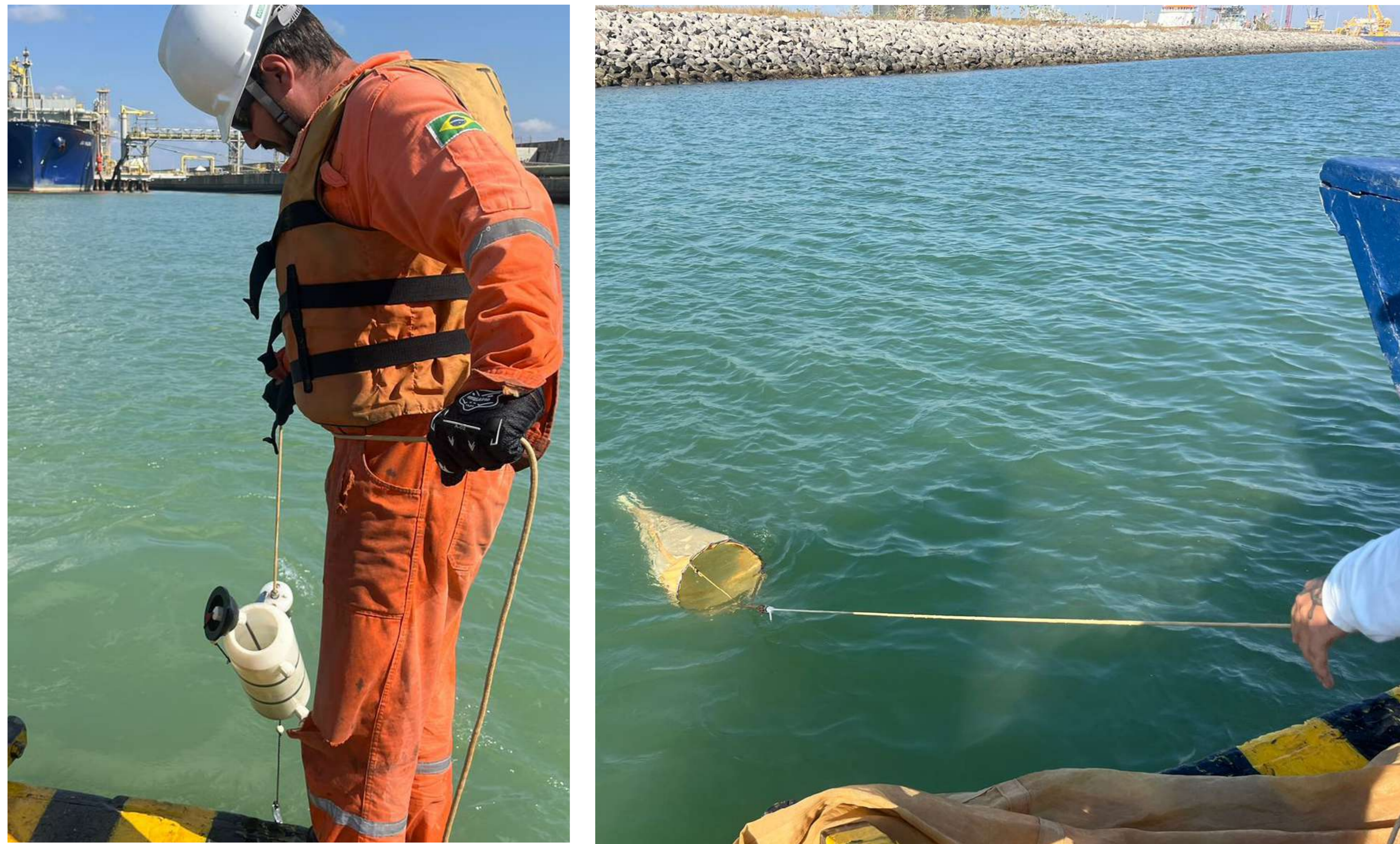
Atividades de Monitoramento da Comunidade Planctônica durante as campanhas de 2023. Amostragem quantitativa com uma garrafa Van Dorn (esq.); B – Amostragem qualitativa com malha de 20 µm (dir). FONTE: ETHICA
