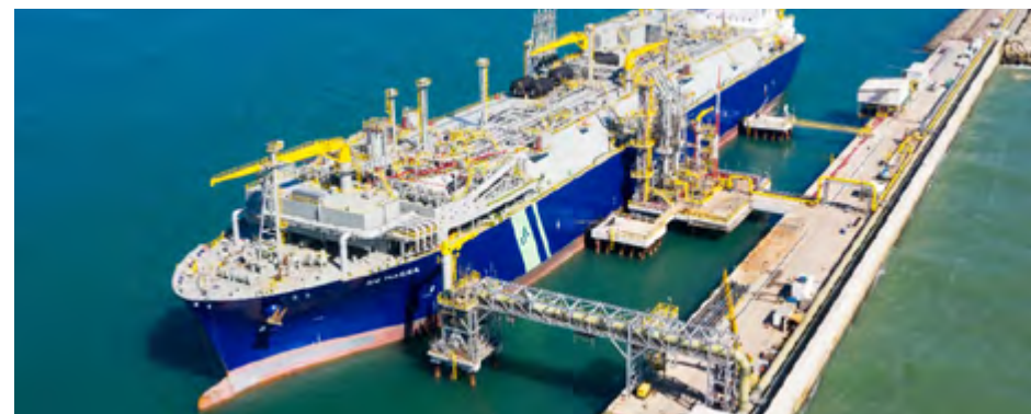
FSRU com casco pintado de azul marinho e convés de cinza: redução da refletância da luz na água. Fonte: GNA
