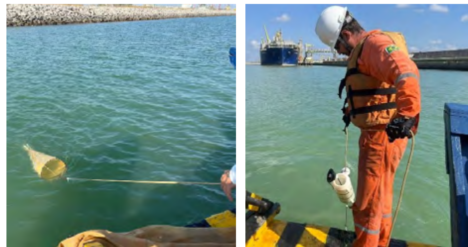
Atividades de Monitoramento da Comunidade Planctônica. Amostragem quantitativa com uma garrafa Van Dorn (esq.); amostragem qualitativa com malha de 20 µm (dir). Fonte: Ethica Ambiental.
