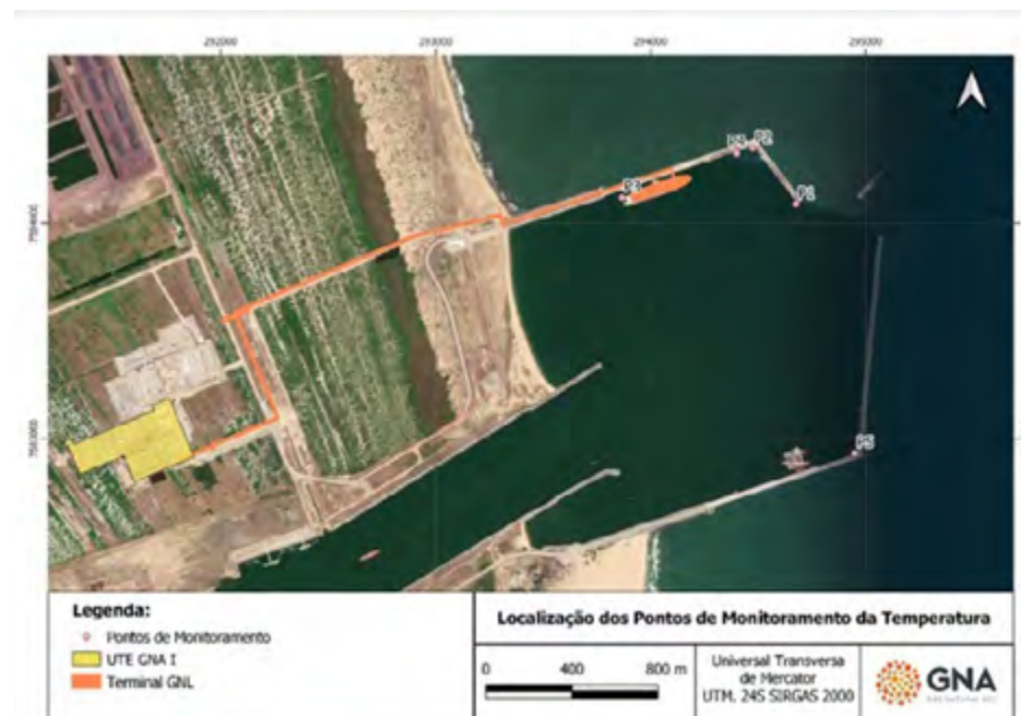
Grade de amostra de medição de faixa de temperatura da água do mar. P5 representa um ponto de controle. Fonte: arquivo GNA.
